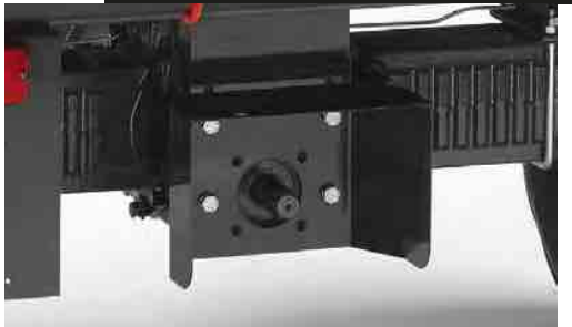
Heckzapfwelle mit 2 Geschwindigkeiten. Prise de force arrière à 2 vitesses.
