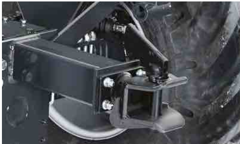
Homologierte Anhängerkupplung hinten. Crochet de remorquage arrière homologué.
